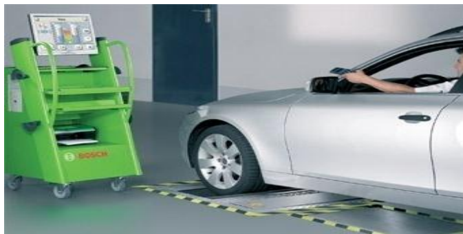
Рис.2. Диагностика тормозной системы на стенде ЛТК-3П-СП-11
